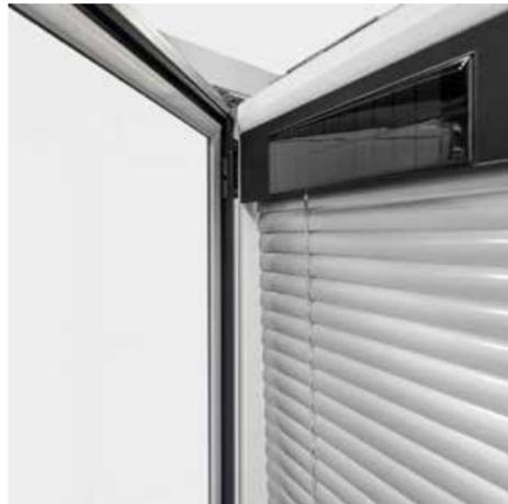
**I-tec Shading** sorgt dank **Photovoltaikmodul und Akku** für eine ideale Raumtemperatur – völlig autark und ohne zusätzliche Stromversorgung! Durch den Automatikmodus öffnen und schließen sich die Jalousien selbstständig bei Sonnenaufgang bzw. Sonnenuntergang. **Die Steuerung erfolgt durch eingebaute Sensoren.** So kann zum Beispiel die Wärme des Sonnenlichts im Winter optimal genutzt werden, da die Jalousien geöffnet bleiben.
