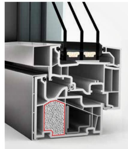
**I-tec Insulation:** Das Isoliergranulat füllt die Hohlkammern umlaufend gleichmäßig aus, wodurch der Wärmeschutz verbessert und die Energiekosten gesenkt werden. Ein Plus für unser Klima und Ihre Geldbörse.
